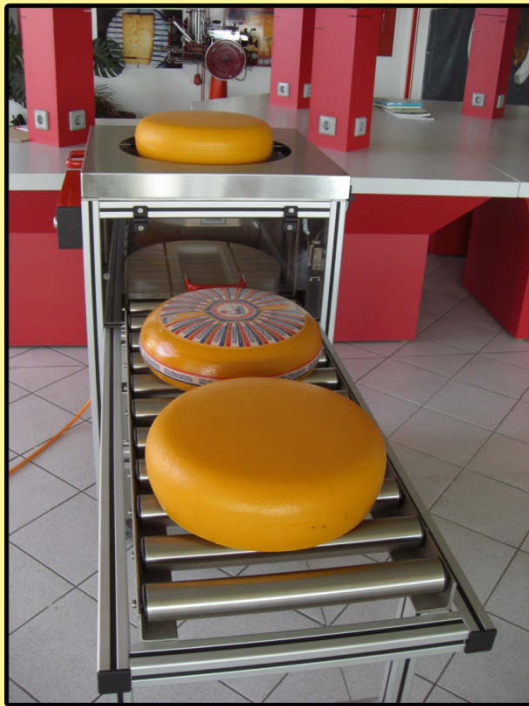
KT3 mit Rollbahn und fertigem Endprodukt; Gouda, jung, 24 Teile
